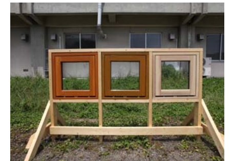
試作した県産スギ製サッシの屋外暴露試験
