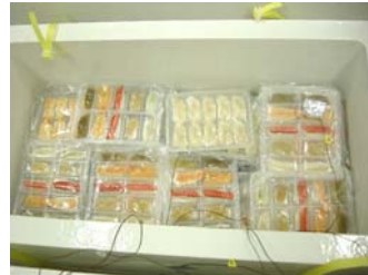
発泡箱各部の温度測定
