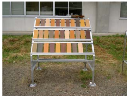
塗装スギ材の屋外暴露試験
