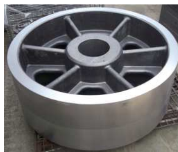
大型シーブの1例（直径1m、重量1t）
