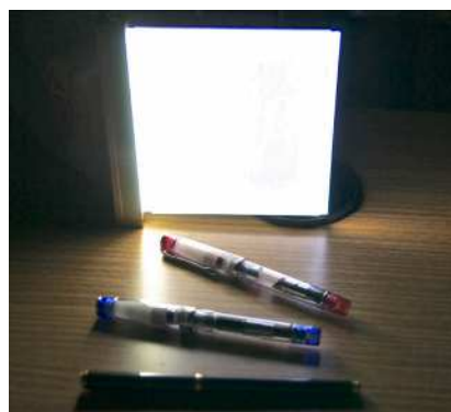
導光板を用いたLED照明の試作品 (LEDは左端にしか入っていません)
