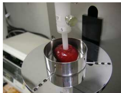
図2 サクランボの圧縮試験 (加工による硬さの変化を評価する)
